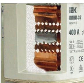
Для быстрого и эффективного дугогашения корпус плавкой вставки наполнен кварцевым песком высокой химической очистки.
