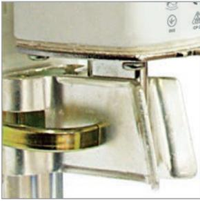
Контакты предохранителя и держателя выполнены из электротехнической меди с гальваническим покрытием сплавом олово-висмут, что предотвращает их окисление в процессе эксплуатации.
